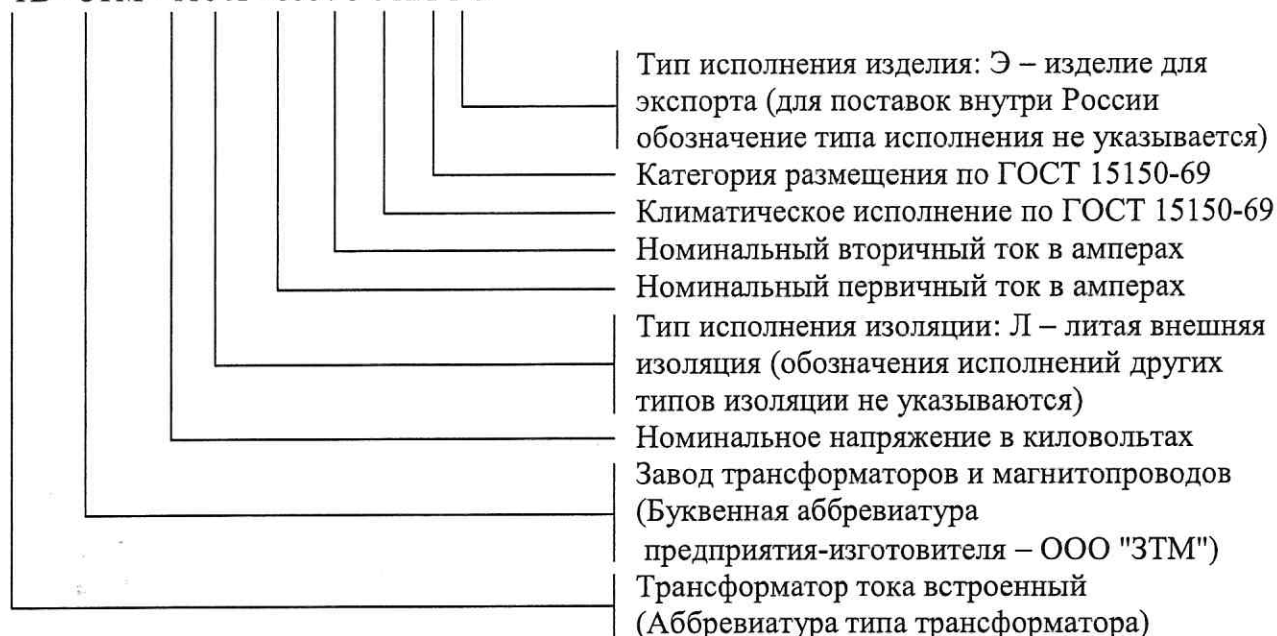
Рисунок 4 - Структура условного обозначения на примере трансформатора тока встроенного ТВ-ЗТМ-110Л-600/5 УХЛ1 Э
